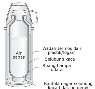
■ Gambar 4.6 Bagian-bagian Termos
